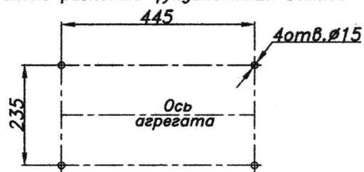
Схема разметки фундаментных болтов
